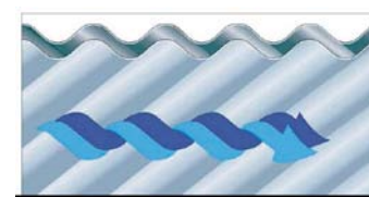
自浄作用を生む波型に成形された伝熱プレート中の乱れの強い流れのイメージ
