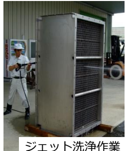
ジェット洗浄作業
