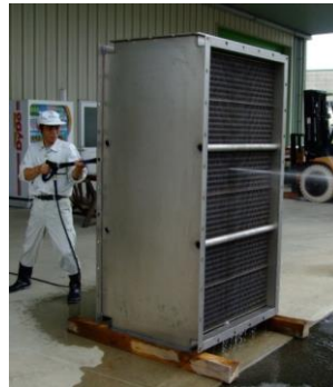
側面を開放しての直接ジェット洗浄
