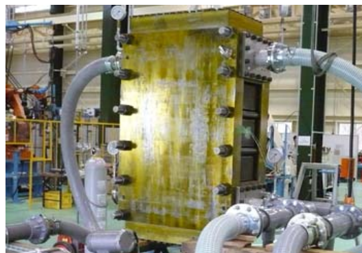
【圧力損失試験】
