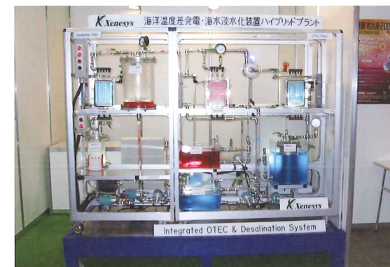
海洋温度差発電で淡水化する装置のしくみ。
