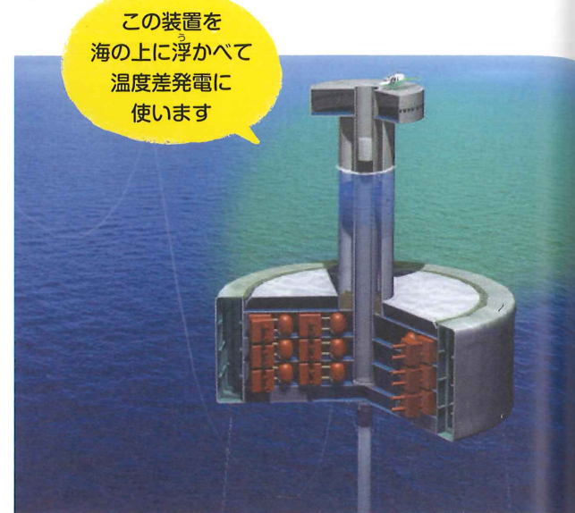
半潜水型の海洋温度差発電装置。装置の上部にある白い線が海面の位置をしめています。
